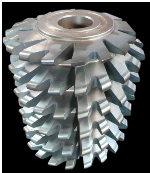
Figura N°3- Creatore con doppia dentatura: denti sgrossatori e denti finitori
